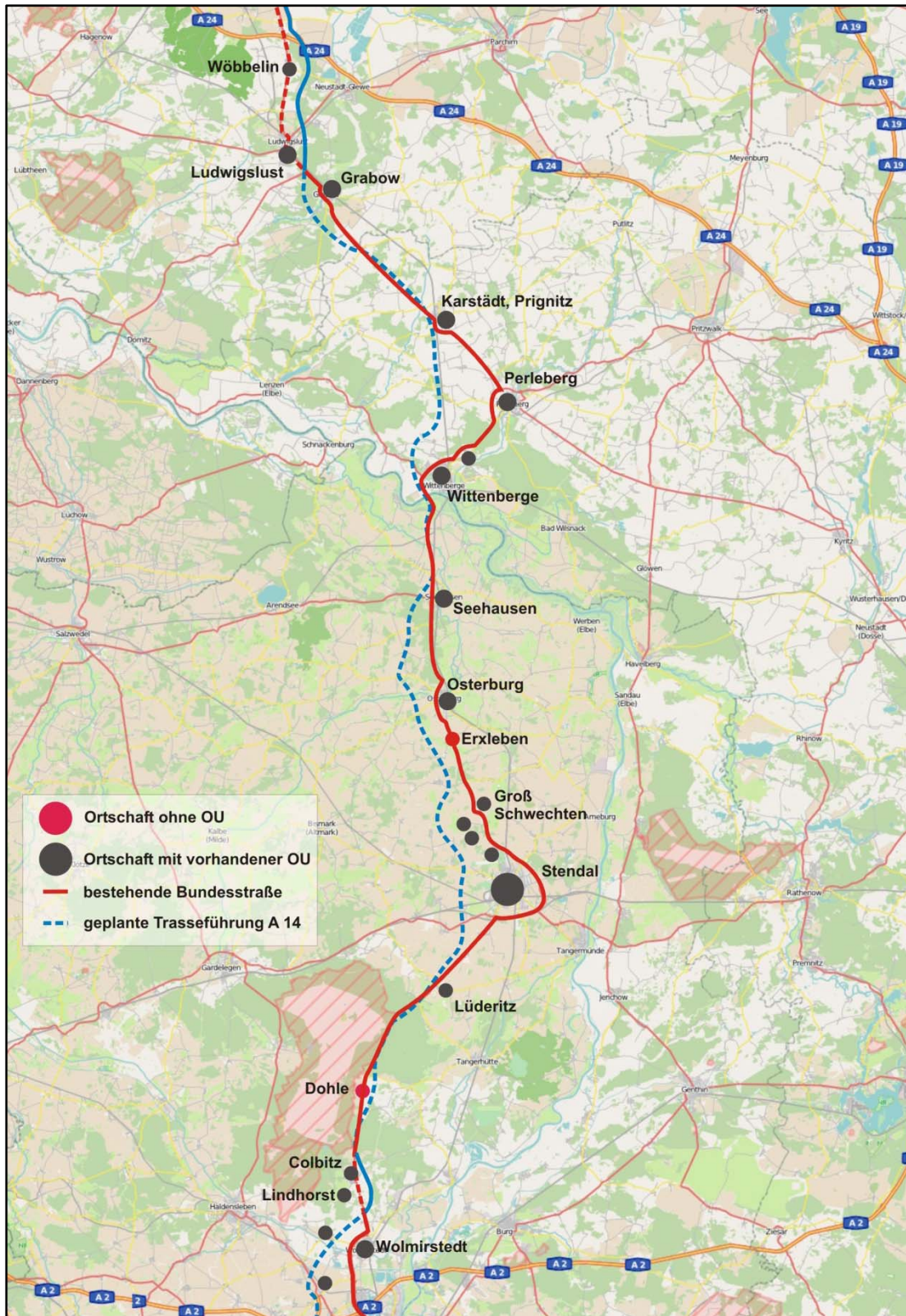
Abb. 9 Parallelverlauf geplante BAB 14 mit den bestehenden B 189 / B 5 / B 106 Kartengrundlage: © OpenStreetMap und Mitwirkende, CC-BY-SA (bearbeitet) http://www.openstreetmap.org/ bzw. http://creativecommons.org/licenses/by-sa/2.0/
